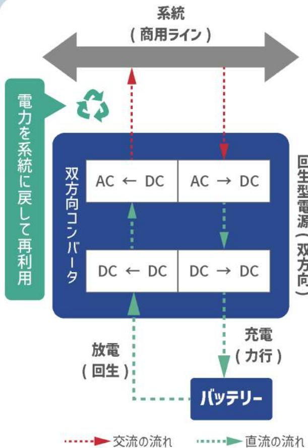
系統（商用ライン）を直流に変換してバッテリーを充電したり、その逆にバッテリーを放電し、直流を交流に変換して系統に戻して再利用するなど、電力を無駄なく活用できる電源です。
