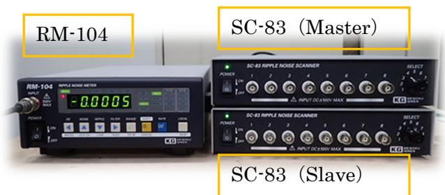
SC-83 はスイッチング電源の出力切り替え機として開発されたスキャナです。各入力チャンネル間の GND は絶縁されているが、100MHz の周波数帯域を実現しました。チャンネル数は標準で 8 チャンネル、Master-Slave 接続することで最大 16 チャンネルまで拡張可能です。
