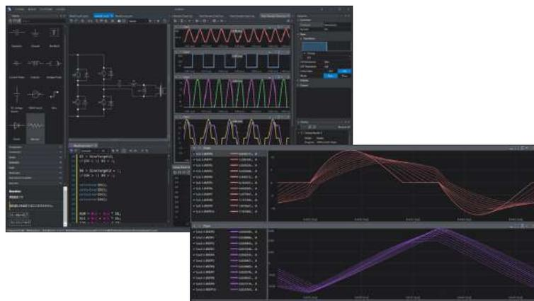
「Scideam (サイディーム)」は、電源開発、パワーエレクトロニクス開発に特化した国産の高速回路シミュレータです。高速性と収束性が高く、かつ解析精度を落とさない独自のシミュレーションアルゴリズムを基に多彩な機能でパワーエレクトロニクス開発を支えます。
