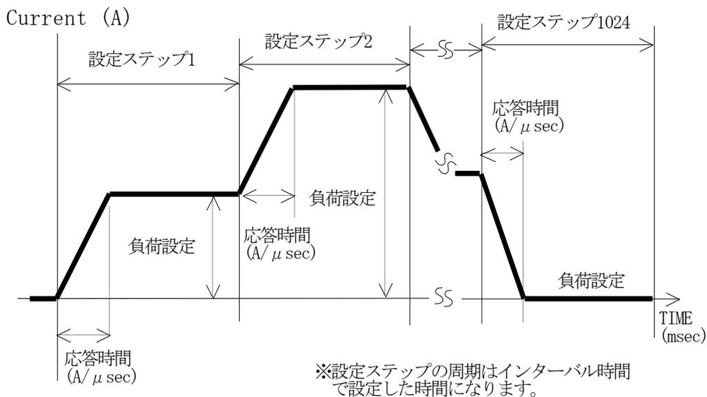
図 5-13-1 シーケンス負荷時の波形特性図 (CC モードの場合)
