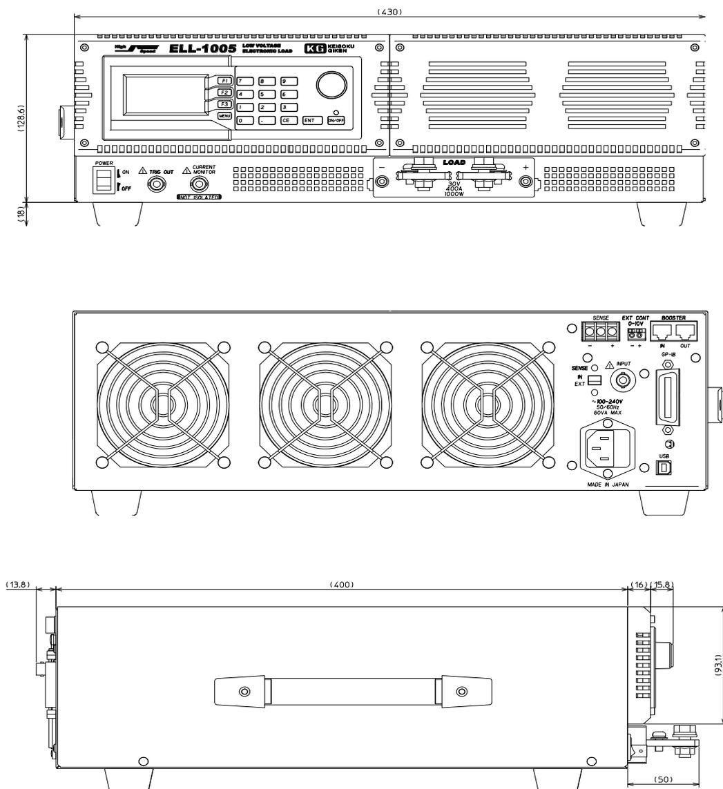
図 10-5-2 Load Edge Series (ELL-1005) 外形図
