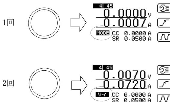
図 6-3-1 電圧レンジの変更方法-1
