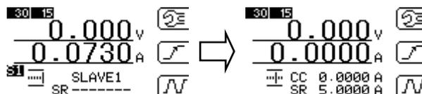
並列運転から単独運転に戻すときは、各器の電源をオフにした後、BOOSTER 接続ケーブルを外してください。
