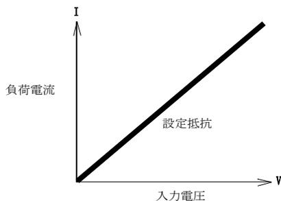
負荷電圧に比例した電流が流れる抵抗を模擬した負荷モードです。抵抗と同様の動作をしますので、一般的な負荷の模擬に適しています。
