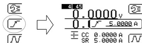
図 5-3-1 定電流・外部制御モード応答速度変更手順
