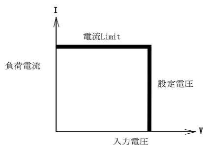
環境設定の電流リミット機能を使って、定電圧モード時の負荷電流を制限できる負荷モードです。電池の放電特性の模擬に最適です。電流リミットで設定した値の 110%程度（目安）で電流制限をかけることができます。
