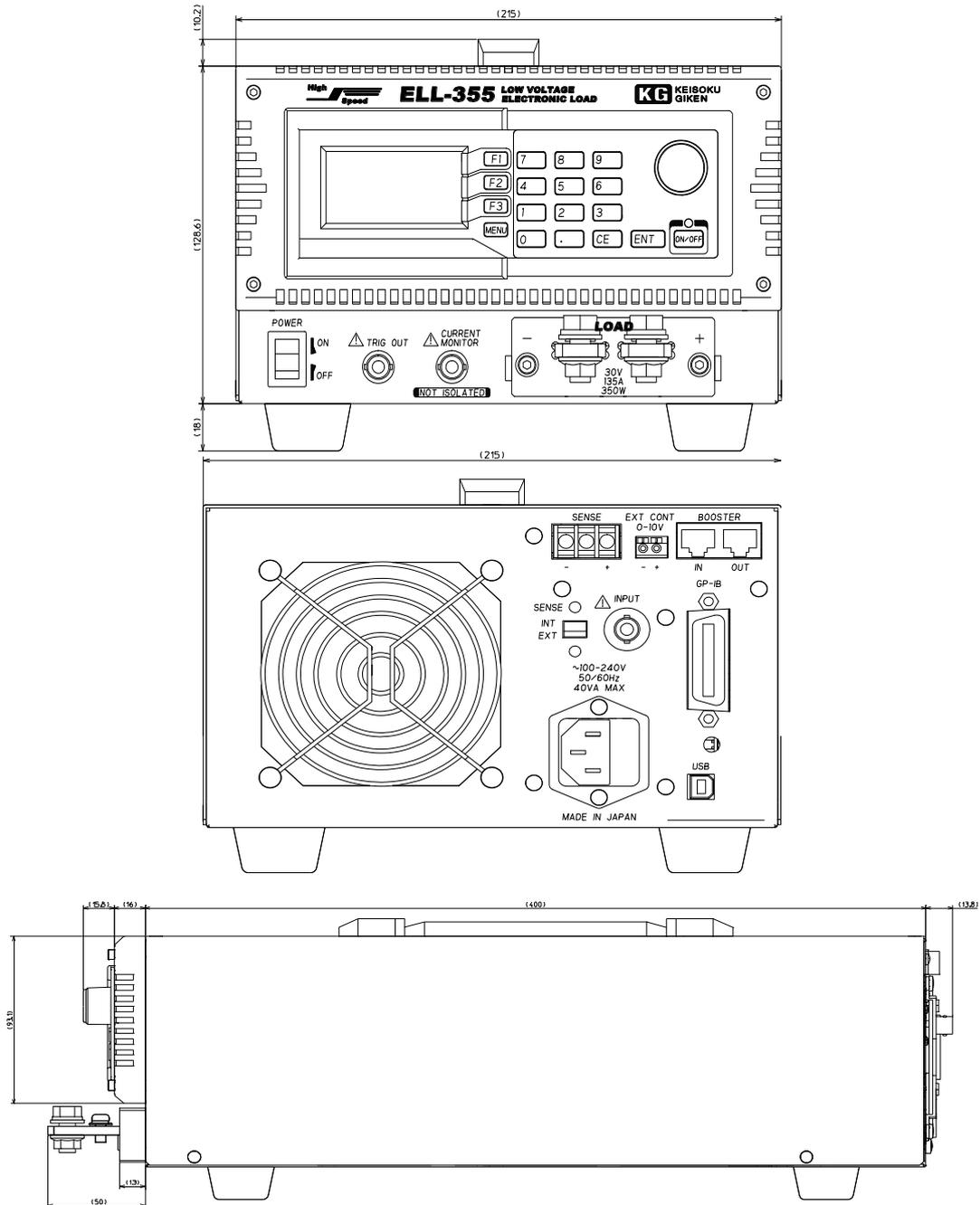
図 10-5-1 Load Edge Series (ELL-355) 外形図
