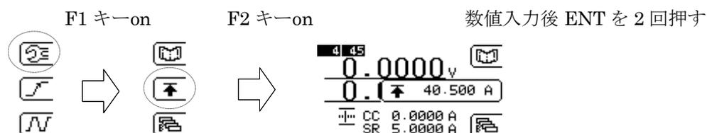
図 5-4-1 電流リミット変更手順
