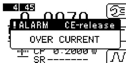
図 7-1-1 過電流リミット時の表示器
