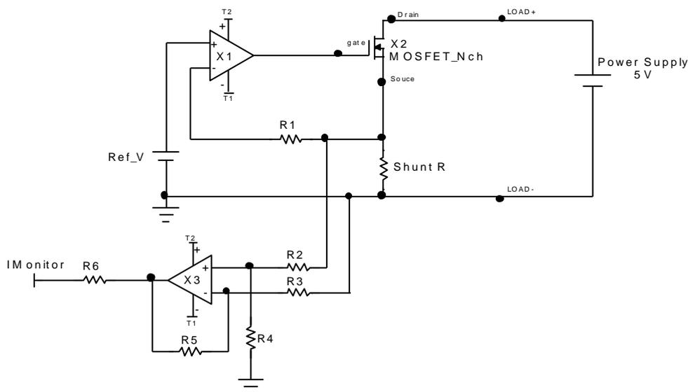
図 2-4-1 電流モニタ等価回路
