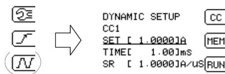
図 5-12-2 動的負荷モードの呼び出し手順
