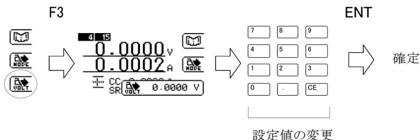
図 5-9-3 切り替え電圧指定の操作手順
