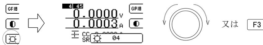
図 4-4-4 バックライトの明るさ設定方法
