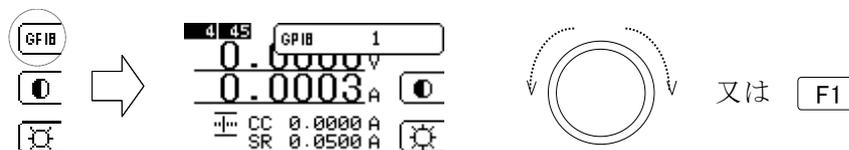
図 4-4-2 GPIB アドレス設定方法
