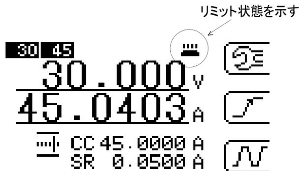
図 7-6-1 瞬間電力制限状態時の表示器
