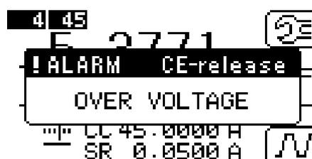
図 7-2-1 過電圧アラーム時の表示器
