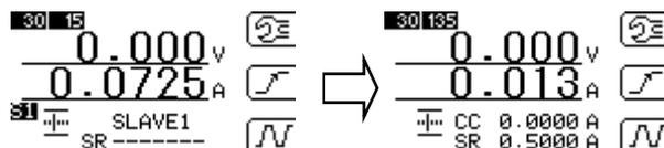
マルチチャンネル同期運転から単独運転に戻すときは、各器の電源をオフにした後、BOOSTER 接続ケーブルを外してください。
