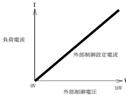
背面の EXT 端子に入力された電圧に比例した負荷電流が流れる負荷モードです。
