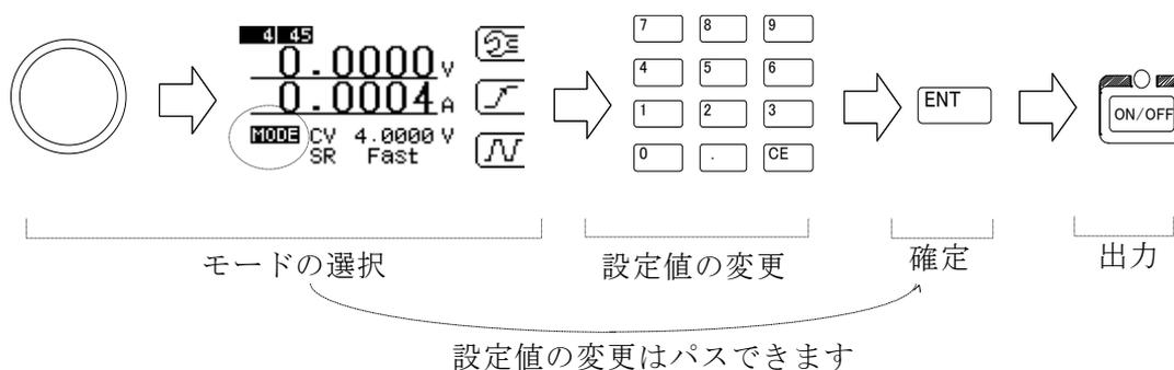
図 5-7-1 CV モードの操作手順
