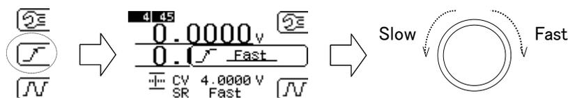
図 5-3-2 定電圧モード応答速度変更手順
