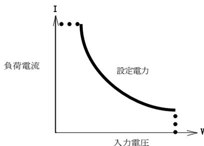
負荷電力が一定になるように負荷電流が変化する負荷モードです。スイッチング電源のように電圧が下がると電流が増加するような装置を模擬するのに最適となります。
