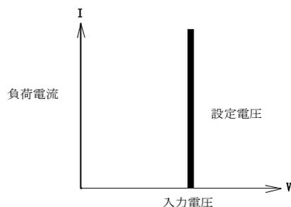
内部抵抗を有する電源において、負荷電圧が一定となるよう負荷電流が変化する負荷モードです。充電式のバッテリーなどの模擬に最適です。
