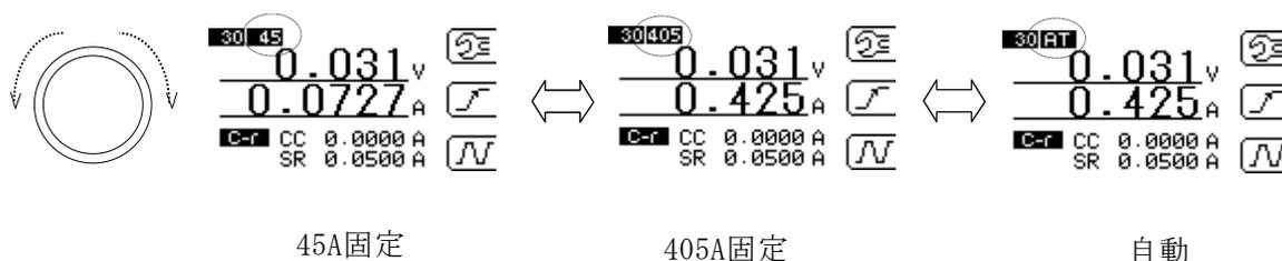
図 6-3-4 電流レンジの変更方法-2
