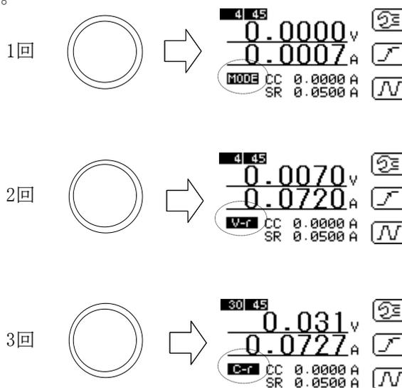
図 6-3-3 電流レンジの変更方法-1
