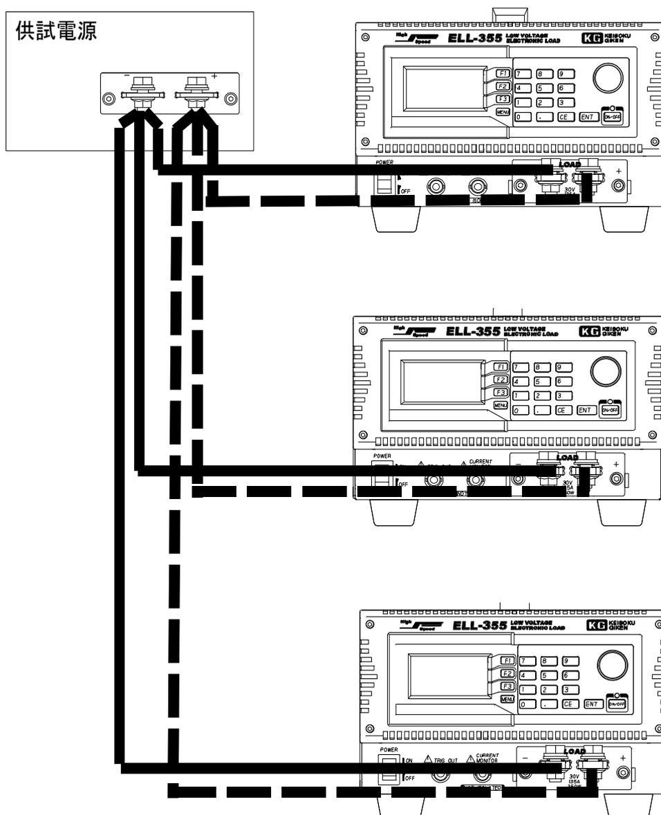
図 9-1-1 スレーブ器 2 台の並列接続
