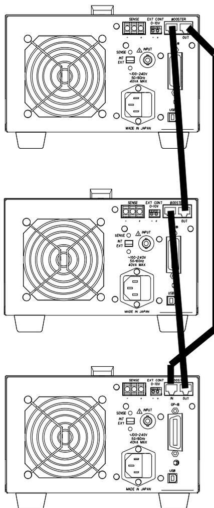
図 9-1-2 スレーブ器 2 台の並列接続
