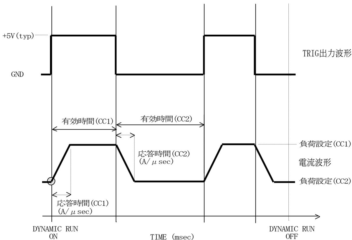
図 2-5-1 TRIG OUT 出力と電流波形の関係
