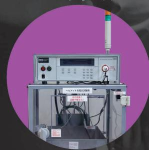
超高電圧耐圧試験器
