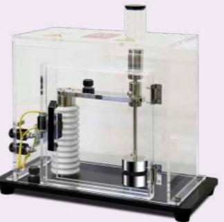
JISC2110規定の電極治具で試験可能な試験治具です。出力中に扉開閉されても、シャットダウンし安全です。
