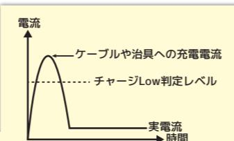
容量成分に瞬間に充電される電流を検出することで、試験物と耐圧試験機との接続の有無を判断します。
