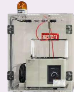
高電圧時の空気放電がなく直線的に供試デバイスに電圧を印加可能な試験治具です。標準で200°C特注で250°Cの温度まで上昇でき、半導体試験でのジャンクション温度を再現しながら、絶縁耐量の試験ができます。
