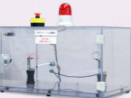
トランジスやモーターの配線に使われてるUEWなどのケーブル耐圧試験用の治具装置です。
