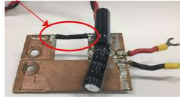
高速DC/DCコンバータ (POL/LDO) 向け 低インダクタンス配線基板 (生基板で作成)
