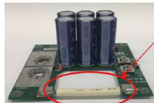
電流センサ向け 低インダクタンス治具基板 (特注)
