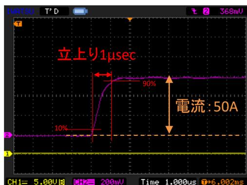
**ELL-355は1A～50Aまで1μs以内での高速電流応答に特化しています。**
