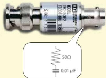
スイッチング電源のリプルノイズ測定をする際、特性インピーダンス50Ωの同軸ケーブルで測定信号を伝送し、これを50Ωで終端するためのものです。
