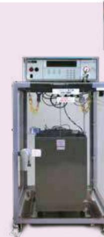
電気用安全帽に加え、電気用ゴム手袋と電気用長靴の耐電圧試験が可能な汎用モデルです。
