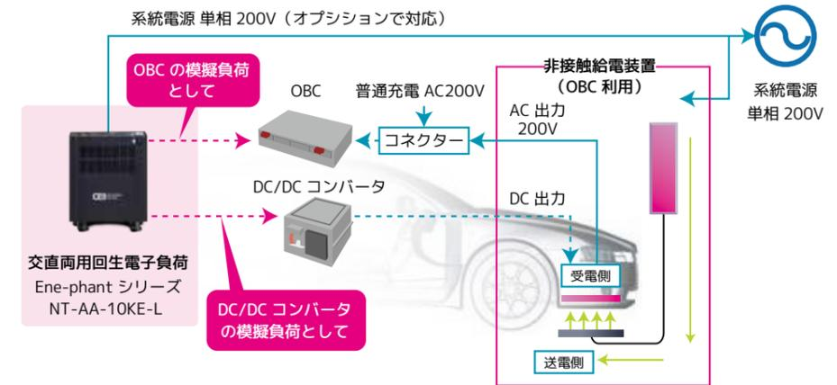
現在採用されている非接触充電器にはOBCを利用して、ACインバータ出力が用意されております。交直両用電子負荷は、ACおよびDCに対応した負荷で、このACインバータ出力の評価と今後採用されるDC出力の両方とも評価が可能です。
