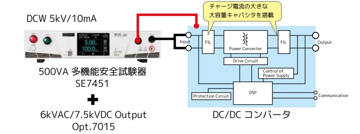
オートモーティブにおいて、DC6kVで20mAの漏れ電流試験が要求されております。20mAの漏れ電流はキャパシタにチャージされる時の短絡的な電流となります。SE7400シリーズには、この短絡電流の時間は判定しないモード (Ramp Hiモード) ならびに電圧を徐々に上げる機能 (Ramp Upモード) を利用して、検査が可能です。
