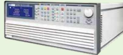
単相1.875kWからマスタースレーブにより単相30kW、三相11.25kWまで容量拡張可能です。AC整流負荷のシミュレーション(IEC62040-3)に対応しております。
