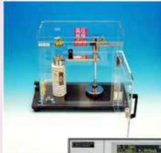
半導体の高耐圧試験用途に伴い、JISC2110規格にて規定されている電極治具に加えてさらに安全面の機能を強化した気中電極治具装置です。
