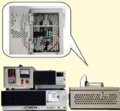
任意の電流パターンを印加可能。マイクロALNホットプレートによりDUT加熱時の試験にもご利用頂けます。
