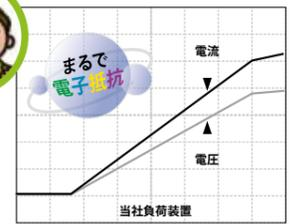
0Vから電圧変化に対して直線的に電流も変化する、まさに抵抗器のような特性を実現！
