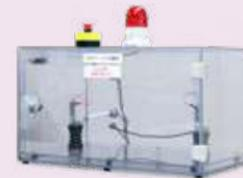
トランスやモーターの配線に使われてるUEWなどのケーブル耐圧試験用の治具装置です。
