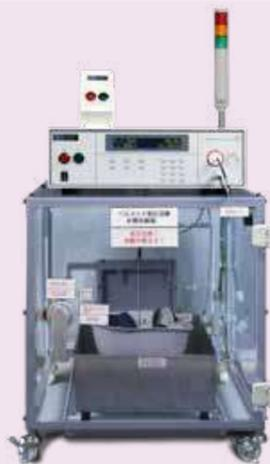
労働安全衛生法の規定により6か月に1回実施する絶縁用保護具の耐圧試験を、特別な資格不要でJIS T 8131等に準拠した環境下でいつでもどこでも行うことができます。その上試験は3分で完了。代替の準備も不要です。
