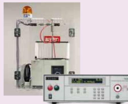
半導体の高耐圧試験用途増加に伴い、JIS C 2110規格にて規定されている電極治具として、最大200℃、特注で250℃まで温度可変可能です。これにより、ジャンクション温度上昇時の絶縁耐量の測定を行うことが可能です。
