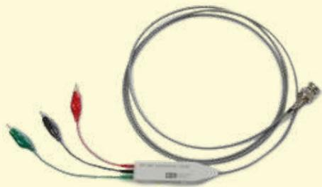
スイッチング電源のリプルノイズ測定をする際、測定誤差の要因となるコモンモードノイズを除去し、測定端子間の真の信号電圧を測定するための差動プローブです。
