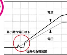
最小動作電圧よりも低い領域では電流が流れず図のような歪みが発生します。
