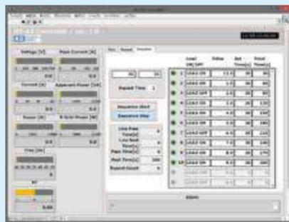
負荷模擬試験に適した連続変動試験が可能なシーケンス設定やPC側からマニュアル操作可能なモードをパッケージ化した無償ソフトです。シーケンス設定においては、CSV形式で試験内容の保存や編集が可能です。LANインターフェースを採用しておりますので、簡単にPCと接続し遠隔で制御することができます。弊社WEBより、無償でご提供しております。
