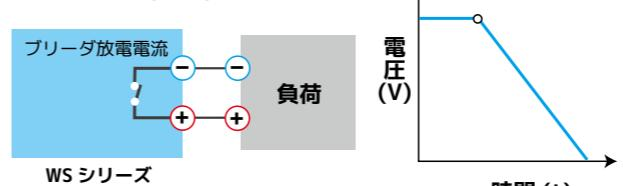
出力OFF時において、出力コンデンサの電荷を放出させ、すばやく出力電圧を下げる機能です。ただし、バッテリーなどを接続した場合、出力OFFでも放電してしまう為注意が必要です。
