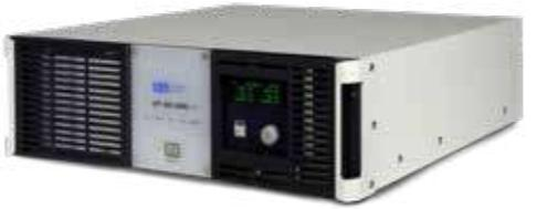
系統側（AC 側）と HVDC（DC350～400V）間の 2kW 電力変換を行い、系統接続に対し系統連系ガイドラインに沿った各種監視項目を網羅しております。系統側（AC 側）への回生 / 力行の出入口となります。並列運転<sup>\*1</sup>による容量拡張も可能です。
