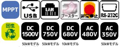
交直両用/直流回生電子負荷Ene-phantシリーズは、10kWならびに50kWの容量とAC350V～480V、DC350V～1500Vまで計5種類の負荷電圧モデルを用意。回生型電子負荷で唯一の交流負荷となっており、三相対応から力率可変まで幅広い用途にお使いいただけます。また交直問わず使用できる為、マルチ入力可変PCSとして使用することができ、風力発電・太陽発電からバイオ燃料を利用したバイオ発電まで実証実験などに利用することができます。
