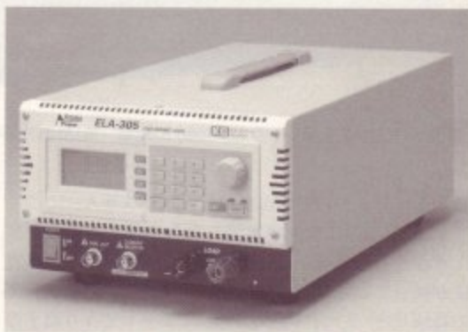
〈写真1〉一般の電源装置の測定・評価に使用される電子負荷の一例
