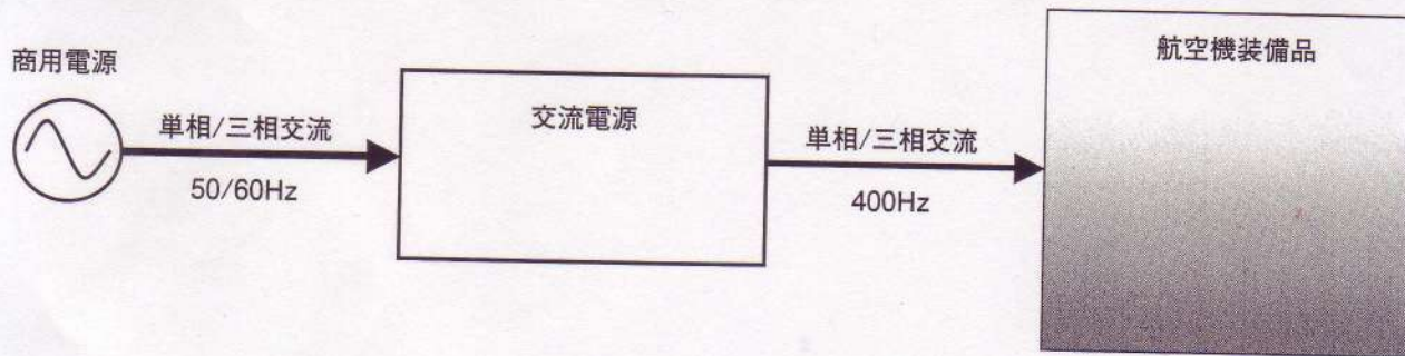
図1 交流電源による電源入力試験構成図
