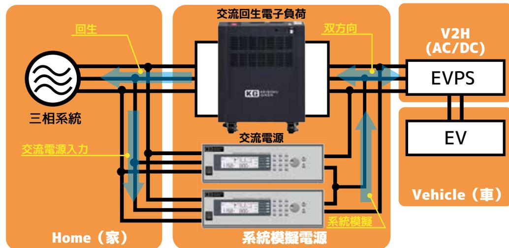
交直両用回生電子負荷と交流電源を使い、双方向性をもった系統電源を模擬しております。交流電源は逆電流保護機能があり、逆電流が発生した場合でもシャットダウンし保護します。また回生した電力を交流電源の入力電力に利用(構内回生)することにより省エネの実験が可能です。
