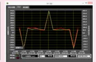
各パワーユニット等により測定した系統電圧などをグラフ化することができます。
