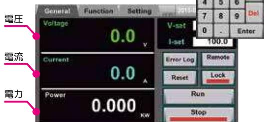
大型タッチパネルディスプレイを採用し、誰でも簡単に操作可能です。電圧・電流・電力の3つの測定を同時に表示することができます。視認性も高い色配置と文字サイズにしており、遠い場所から一目で電源の状態を把握することが可能です。
