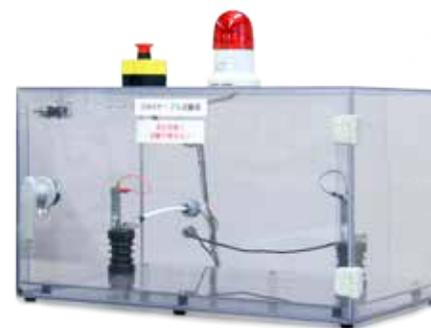
トランスやモーターの配線に使われてるUEWなどのケーブル耐圧試験用の治具装置です。
