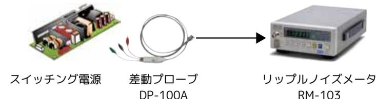
電源内部に実装されている有寿命部品(アルミ電解コンデンサ)の劣化を想定して交換時期が決められており、平滑能力低下の指標としてリップル電圧を測定することで、メンテナンス時に交換の指標として使用します。メンテナンス現場では個人差がなくワンタッチで測定が可能です。
