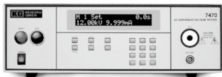
ランプアップ機能により徐々に電圧を上昇させ、途中でリミット電流を超えた場合高電圧の印加を自動停止します。
