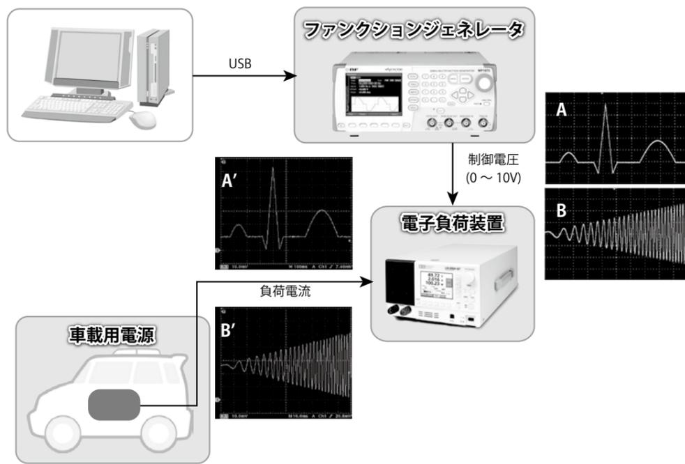
ファンクションジェネレータ単体でのパラメータ可変波形、シーケンス機能、さらにPCを接続して任意波形作成ソフトウェアにより多種多様な波形を生成することができます。
