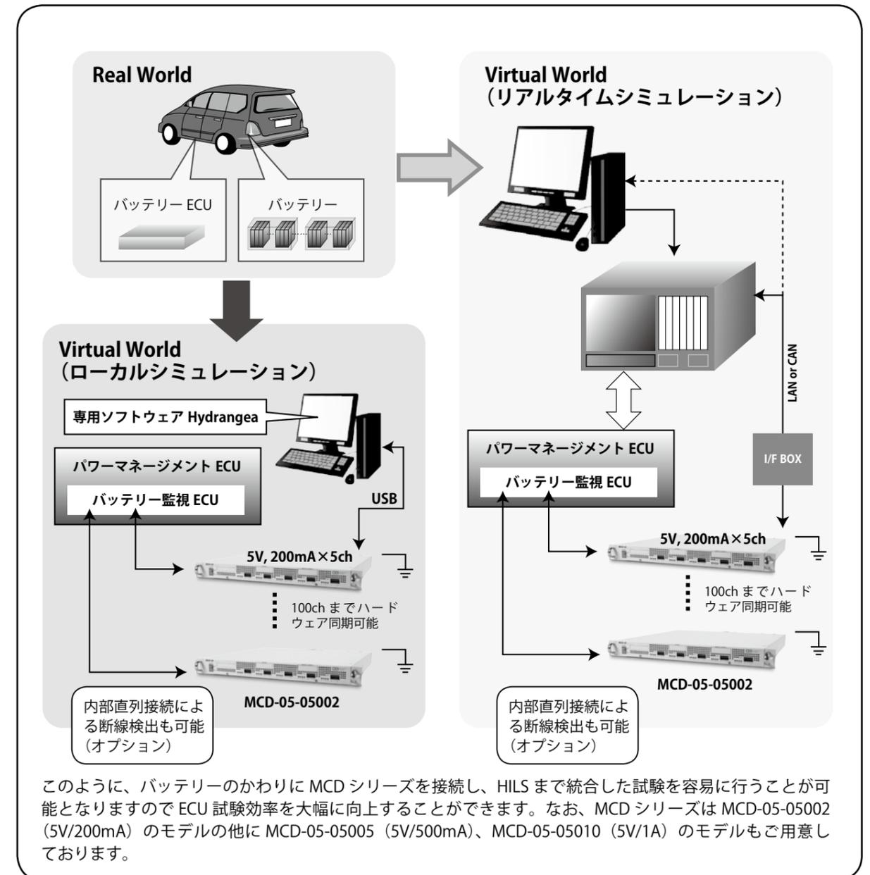
このように、バッテリーのかわりに MCD シリーズを接続し、HILS まで統合した試験を容易に行うことが可能となりますので ECU 試験効率を大幅に向上することができます。なお、MCD シリーズは MCD-05-05002 (5V/200mA) のモデルの他に MCD-05-05005 (5V/500mA)、MCD-05-05010 (5V/1A) のモデルもご用意しております。
