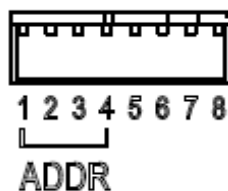
図 3-1-3 アドレス設定スイッチ拡大図
