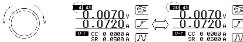
図 6-3-2 電圧レンジの変更方法-2
